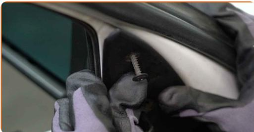
**13** Schrauben Sie die Innenverkleidung fest, welche die Befestigungsschrauben des Außenspiegels verdecken soll. Verwenden Sie einen Kreuzschlitzschraubendreher.
