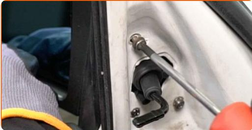
**12** Montieren Sie die Abdeckung des Außenspiegels.
