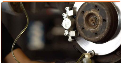
**35** Die Bremsscheibenoberfläche reinigen. Benutzen Sie eine Drahtbürste. Behandeln Sie die Kontaktfläche. Benutzen Sie ein Kupferschmiermittel.
