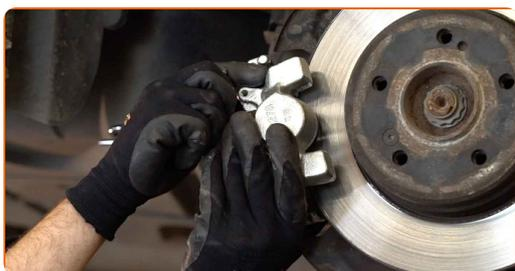
**23** Ziehen Sie die Bremssattelbefestigungen fest. Verwenden Sie Stecknuss Nr. 16. Verwenden Sie einen Drehmomentschlüssel. Ziehen Sie ihn mit 55 Nm Drehmoment fest.
