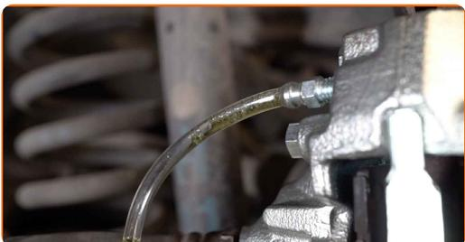
**33** Ziehen Sie die Bremsentlüftungsschraube an. Verwenden Sie Ring-Gabelschlüssel Nr. 9.
