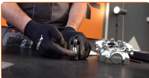
**21** Schrauben Sie den Bremssattel auf die Bremsleitung.
