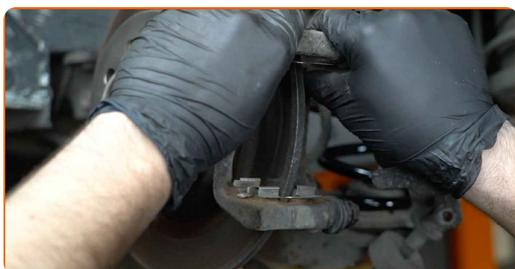
**18** Entfernen Sie den Bremsbelagverschleißsensor vom Bremsbelag. Verwenden Sie einen flachen Schraubendreher.
