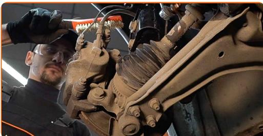
**10** Schrauben Sie die Befestigung des Bremssattels ab. Verwenden Sie Inbusschlüssel Nr. H6. Verwenden Sie einen Ratschenschlüssel.
