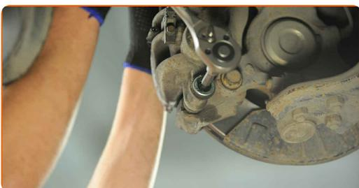
**11** Entfernen Sie die Führungstifte aus dem Bremssattel.
