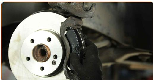
**Austausch: Bremsbeläge – MERCEDES-BENZ SPRINTER 5-t Kasten (906). Fachleute empfehlen:**
