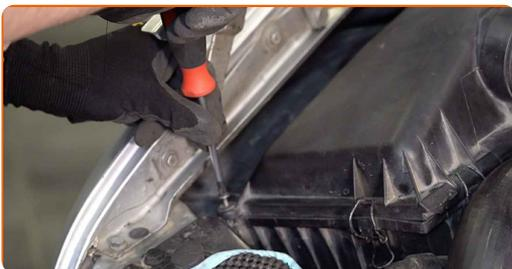
7 Lösen Sie die Befestigungsclips der Luftfilterabdeckung.
