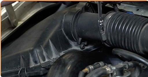
**4** Trennen Sie das Luftansaugrohr vom Luftfilter-Gehäuse. Benutzen Sie ein Brecheisen.
