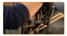
Entfernen Sie den Bremssattel.
