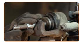
Behandeln Sie den Bremssattelhalter dort, wo er die Bremsbeläge berührt. Benutzen Sie eine Anti-Quietsch-Paste.
