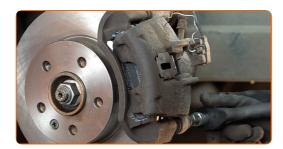
Verbinden Sie den Stecker des Verschleißseonsors der Bremsbeläge.
