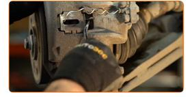
Die Bremssattelbefestigungen reinigen. Benutzen Sie eine Drahtbürste. Benutzen Sie WD-40-Spray.
