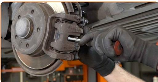
**10** Entfernen Sie die Führungstifte aus dem Bremssattel.
