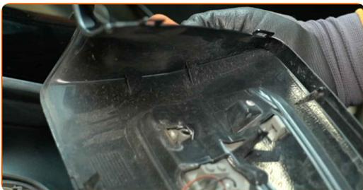
**13** Trennen Sie den Steckverbinder des Seitenblinkers. Verwenden Sie einen flachen Schraubendreher.
