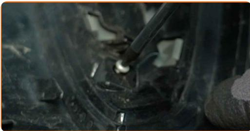
**15** Lösen Sie die Laschen der Zusatzblinker vom Spiegelgehäuse.
