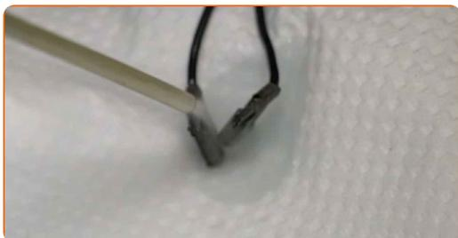
**27** Schließen Sie die Steckverbindungen der Spiegelheizung wieder an.
