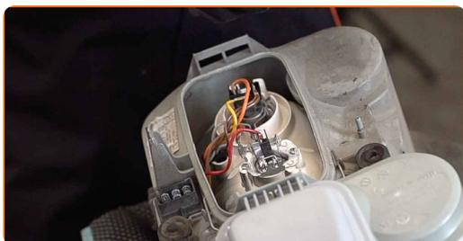
14 Stecken Sie die Steckverbindungen der Scheinwerfer-Glühbirnen aus.
