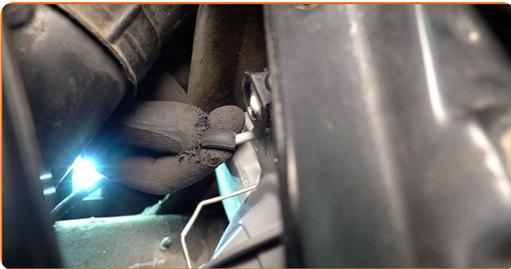
23 Behandeln Sie die Scheinwerfer-Steckverbindungen. Verwenden Sie Elektronikspray.
