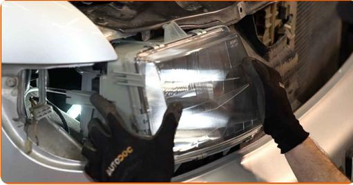
21 Schrauben Sie Scheinwerfer-Befestigungen ein. Verwenden Sie einen Kreuzschlitzschraubendreher.
