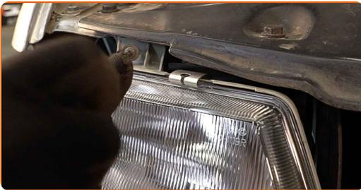
22 Befestigen Sie den Vakuumschlauch am Scheinwerferregler.
