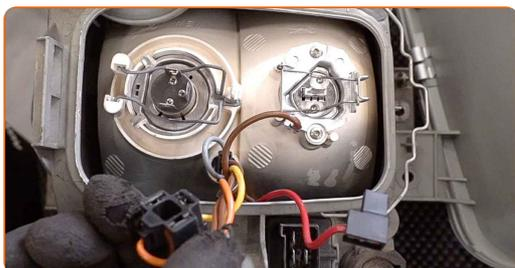
15 Trennen Sie die Halterklammern und entfernen Sie die Glühbirnen vom Scheinwerfer.
