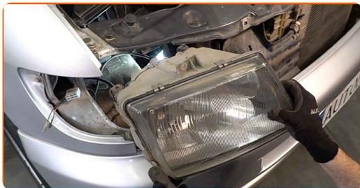
12 Lösen Sie die Halteklammer der Scheinwerfer-Schutzabdeckung.
