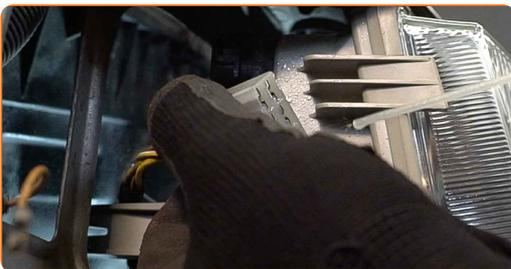
24 Schließen Sie die Steckverbinder der Scheinwerfer an.
