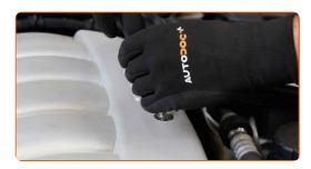
Entfernen Sie den hinteren Teil der Motorabdeckung.
