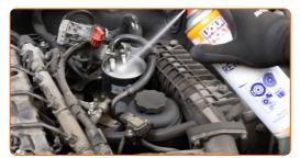
Lösen Sie die Halterung des Kraftstofffilters. Verwenden Sie Inbusschlüssel Nr. H5. Verwenden Sie einen Ratschenschlüssel.
