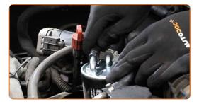
Ziehen Sie die Befestigungsklemme der Kraftstoffversorgungsleitung an. Verwenden Sie Stecknuss Nr. 7. Verwenden Sie einen Ratschenschlüssel.
