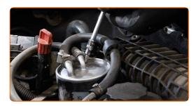
Lösen Sie die Schläuche vom Kraftstofffilter. Verwenden Sie eine Rundzange.
