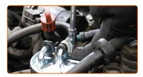
Drücken Sie die Kraftstoff-Entlüftungspumpe mehrere Male, bis diese hart wird. Verwenden Sie einen Kraftstoffpumpball.
