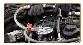
Befestigen Sie die Leitung am Kraftstofffilter.
