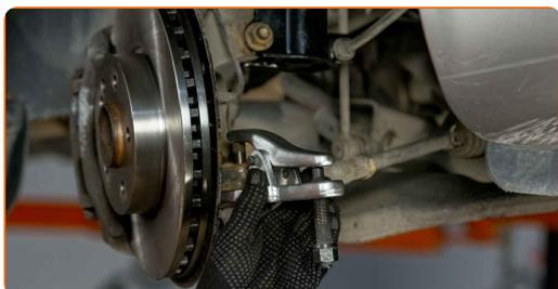
**12** Schrauben Sie das Ende aus der Zugstange.
