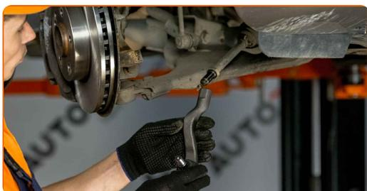
**Austausch: Spurstangenkopf – MERCEDES-BENZ VITO / MIXTO Kasten (W639). Tipp von AUTODOC:**
