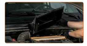
Entfernen Sie das Filterelement aus dem Filtergehäuse.
