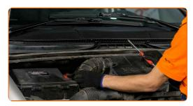
Ziehen Sie die Klemme am Luftansaugschlauch fest. Verwenden Sie einen flachen Schraubendreher.
