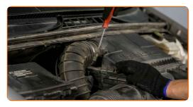
Trennen Sie das Luftansaugrohr vom Luftfilter-Gehäuse.
