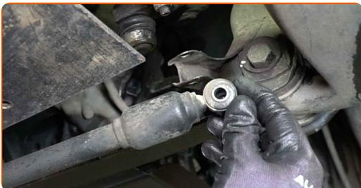
**10** Reinigen Sie die Befestigungsschrauben der Spurstangenköpfe. Benutzen Sie eine Drahtbürste. Benutzen Sie WD-40-Spray.
