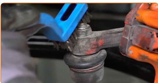
**11** Schrauben Sie die Befestigungsmutter ab, die den Spurstangenkopf mit dem Achsschenkel verbindet. Verwenden Sie Stecknuss Nr. 17. Verwenden Sie einen Ratschenschlüssel.
