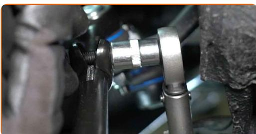
**32** Ziehen Sie die Spurstangenkopf Sicherungsmutter an. Verwenden Sie Ring-Gabelschlüssel Nr. 22. Verwenden Sie einen Drehmomentschlüssel. Ziehen Sie ihn mit 50 Nm Drehmoment fest.
