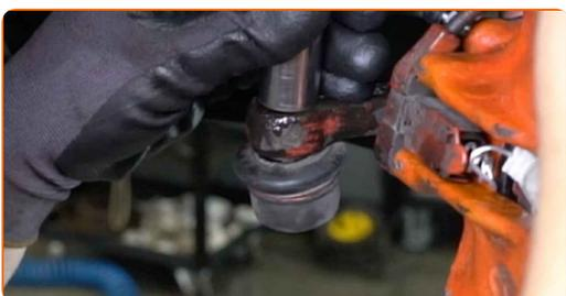
**12** Lösen Sie die Schraube, die den Spurstangenkopf mit dem Lenkwischenhebel verbindet. Verwenden Sie Stecknuss Nr. 17. Verwenden Sie einen Ratschenschlüssel.
