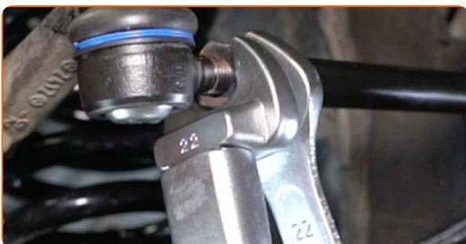
**33** Ziehen Sie die Schraube an, die den Spurstangenkopf mit dem Lenkzwischenhebel verbindet. Verwenden Sie Stecknuss Nr. 17. Verwenden Sie einen Drehmomentschlüssel. Ziehen Sie ihn mit 35 Nm Drehmoment fest.
