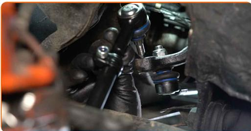
**31** Schrauben Sie die Befestigungsschraube des Spurstangenkopfs fest. Verwenden Sie Ring-Gabelschlüssel Nr. 13. Verwenden Sie Stecknuss Nr. 13. Verwenden Sie einen Drehmomentschlüssel. Ziehen Sie ihn mit 20 Nm Drehmoment fest.
