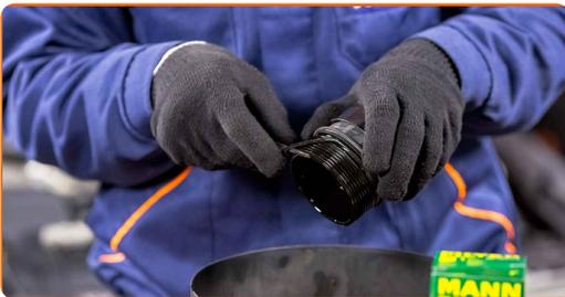
**9** Reinigen Sie den Deckel des Ölfilter-Gehäuses. Verwenden Sie Allzweckreinigungsspray.
