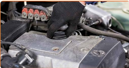
**4** Schrauben Sie den Filtergehäusedeckel zusammen mit dem alten Filterelement ab. Verwenden Sie Steckschlüssel 62-23F. Verwenden Sie einen Ratschenschlüssel.
