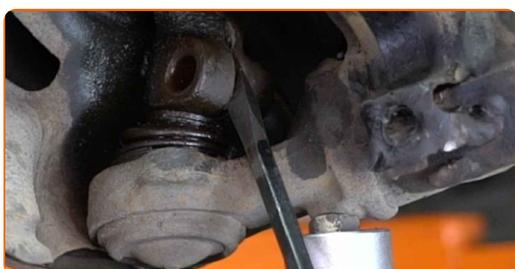
**21** Entfernen Sie die Stütze unter dem Querlenker.
