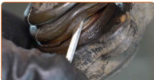
**26** Bauen Sie das Traggelenk aus. Verwenden Sie einen Kugelgelenk-Montage-Satz.
