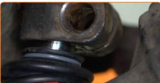
**31** Stützen Sie den Querlenker. Benutzen Sie einen hydraulischen Getriebeheber.
