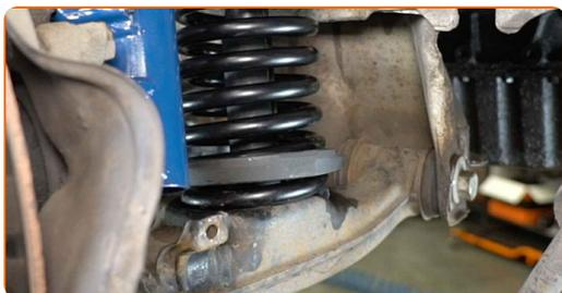
**35** Entfernen Sie den Spiralfederspanner.
