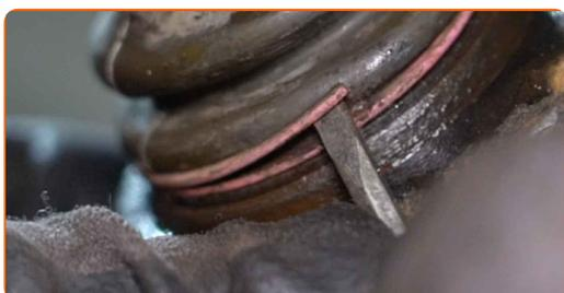
**25** Entfernen Sie die Manschette vom Traggelenk. Verwenden Sie einen flachen Schraubendreher.
