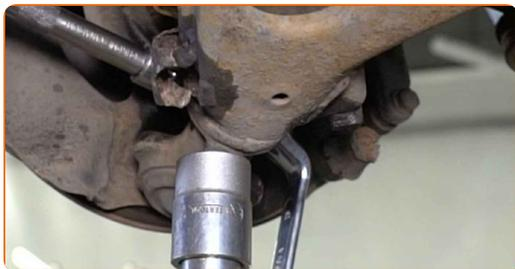
**19** Entfernen Sie die Befestigungsschraube.
