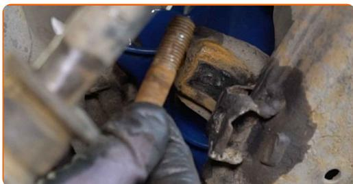
**20** Trennen Sie das Traggelenk vom Achsschenkel. Verwenden Sie einen flachen Metallmeißel. Benutzen Sie einen Hammer. Benutzen Sie ein Brecheisen.
