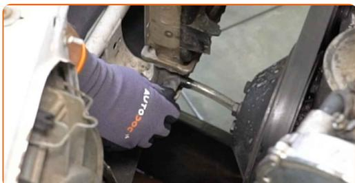
**10** Lösen Sie den oberen Kühlmittelschlauch.
