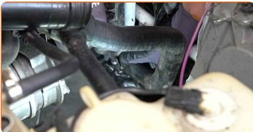
**31** Bringen Sie den oberen Kühlmittelschlauch an.
