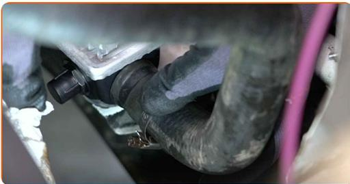
**30** Ziehen Sie die Schelle des unteren Kühlmittelschlauchs fest. Verwenden Sie Stecknuss Nr. 7. Verwenden Sie einen Ratschenschlüssel.
