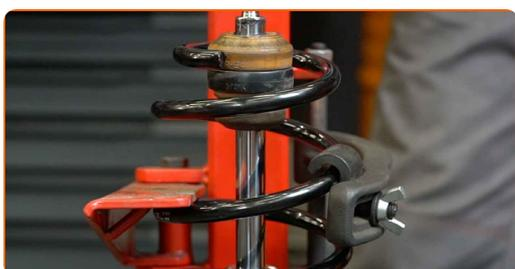
**43** Bringen Sie das Stützlager, die Manschette und den Anschlagpuffer auf dem Stoßdämpfer an.
