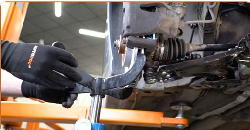
**29** Entfernen Sie die Befestigungsschraube.
