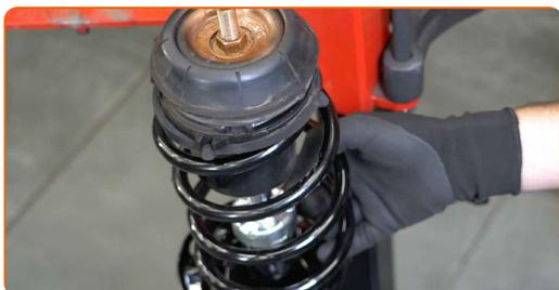
**48** Reinigen Sie die Anbringungssitze des Federbeins. Benutzen Sie eine Drahtbürste. Benutzen Sie WD-40-Spray.
