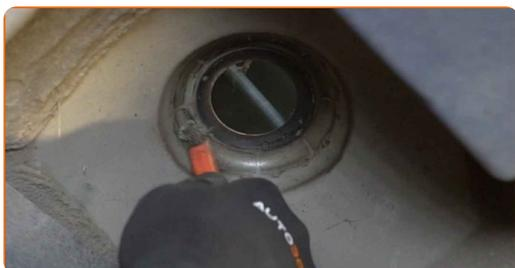
**49** Installieren Sie das Federbein am Radlauf.
