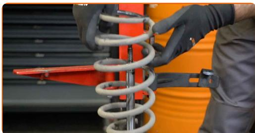
**41** Installieren Sie die Feder am Stoßdämpfer.
