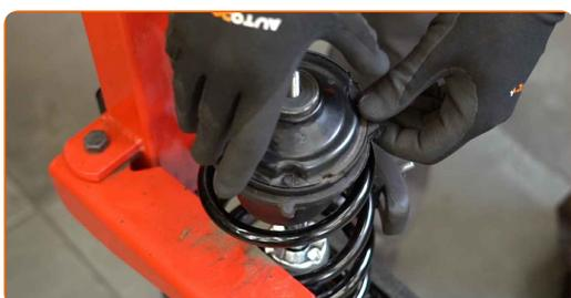
**44** Ziehen Sie die Federbeinkolbenstangenmutter an. Verwenden Sie einen Stoßdämpfer Steckschlüsseinsatz №DD9. Verwenden Sie Ring-Gabelschlüssel Nr. 18. Verwenden Sie einen Drehmomentschlüssel. Ziehen Sie ihn mit 50 Nm Drehmoment fest.
