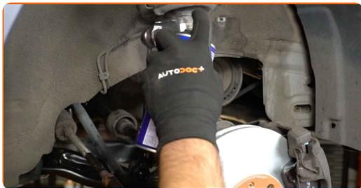
**22** Schrauben Sie das Befestigungselement heraus, das die Druckstange mit dem Federbein verbindet. Verwenden Sie Stecknuss Nr. 19. Verwenden Sie einen Ratschenschlüssel.
