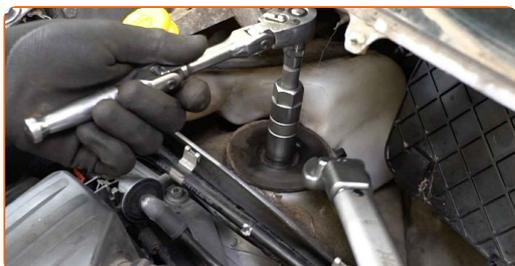
**67** Behandeln Sie die Befestigungselemente des Federbeinstützlagers. Benutzen Sie ein Kupferschmiermittel.
