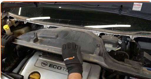
**69** Drehen Sie die Befestigungen in die Spritzschutzwand/Wasserkastenabdeckung. Verwenden Sie Stecknuss Nr. 8. Verwenden Sie einen Ratschenschlüssel.
