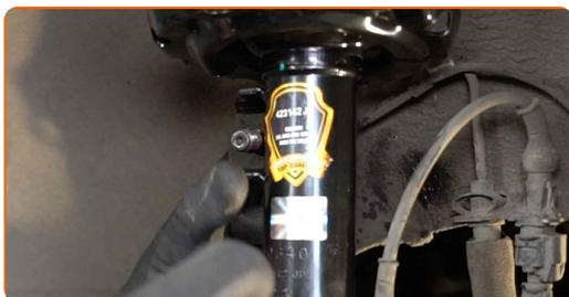
**58** Ziehen Sie das Befestigungselement an, das die Druckstange mit dem Federbein verbindet. Verwenden Sie Stecknuss Nr. 19. Verwenden Sie einen Drehmomentschlüssel. Ziehen Sie ihn mit 55 Nm Drehmoment fest.
