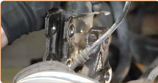
**31** Lösen Sie die obere Befestigung der Federbeinbefestigung.
