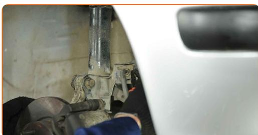
**7** Die Befestigungselemente, die das Federbein mit dem Achsschenkel verbinden, reinigen. Benutzen Sie eine Drahtbürste. Benutzen Sie WD-40-Spray.
