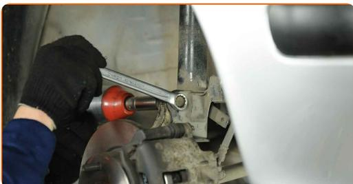
**9** Entfernen Sie die Befestigungsschrauben (2 Stück).
