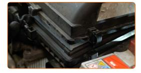
Befestigen Sie die Klammern des Luftfiltergehäuses.
