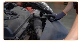
Lösen Sie die Befestigung des Lufteinlassschlauchs. Verwenden Sie einen Lösehebel, um die Clips zu entfernen.
