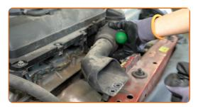
5 Lösen Sie die Klammern des Luftfiltergehäuses.
