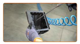
Setzen Sie ein neues Filterelement in das Filtergehäuse ein.
