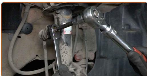
**8** Schrauben Sie das Befestigungselement heraus, das die Druckstange mit dem Stabilisator verbindet. Verwenden Sie Ring-Gabelschlüssel Nr. 17. Verwenden Sie Inbusschlüssel Nr. H5. Verwenden Sie einen Ratschenschlüssel.
