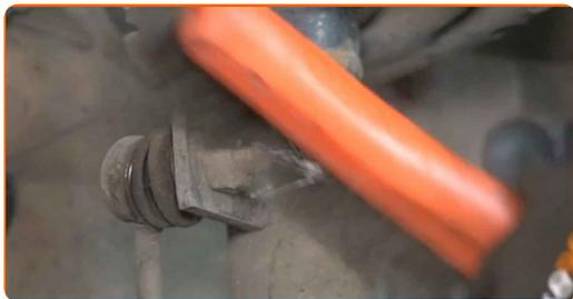
**7** Schrauben Sie das Befestigungselement heraus, das die Druckstange mit dem Federbein verbindet. Verwenden Sie Ring-Gabelschlüssel Nr. 17. Verwenden Sie Inbusschlüssel Nr. H5. Verwenden Sie einen Ratschenschlüssel.
