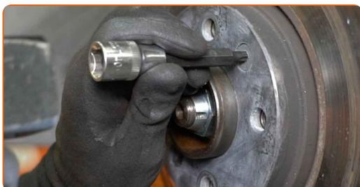
**20** Entfernen Sie die Befestigungsschrauben.
