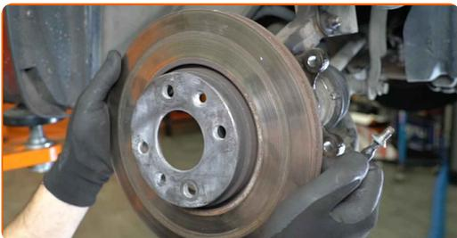
**22** Reinigen Sie die Radnabe. Benutzen Sie eine Drahtbürste.
