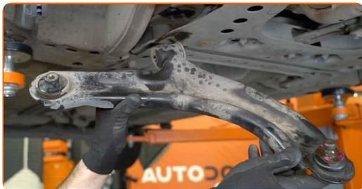
**15** Reinigen Sie die Montagesitze des Querlenkers. Benutzen Sie eine Drahtbürste. Verwenden Sie Allzweckreinigungsspray.
