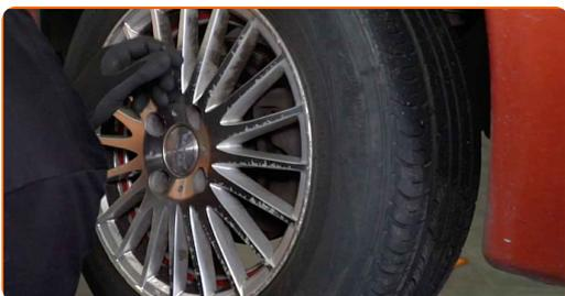
**6** Reinigen Sie die Befestigungen des Querlenkers. Benutzen Sie eine Drahtbürste. Benutzen Sie WD-40-Spray.
