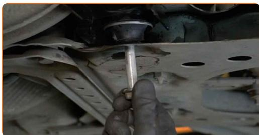
**18** Verbinden Sie das Tragelenk mit dem Achsschenkel.
