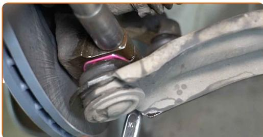
**9** Entfernen Sie die Befestigungsschraube.
