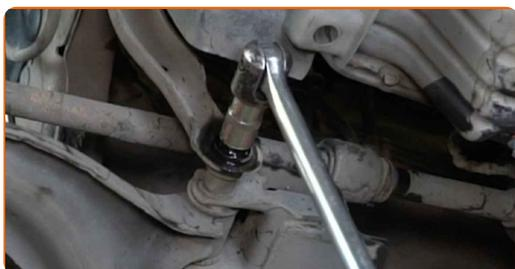
**8** Schrauben Sie die Befestigung ab, die das Traggelenk mit dem Achsschenkel verbindet. Verwenden Sie Ringgabelschlüssel Nr. 16. Verwenden Sie Stecknuss Nr. 16. Verwenden Sie einen Ratschenschlüssel.
