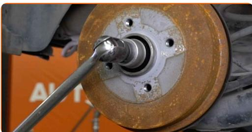
8 Entfernen Sie die Befestigungsmutter.
