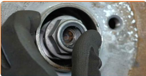
**18** Ziehen Sie die Nabenbefestigung fest. Verwenden Sie Stecknuss Nr. 30. Verwenden Sie einen Drehmomentschlüssel. Ziehen Sie ihn mit 175 Nm Drehmoment fest.
