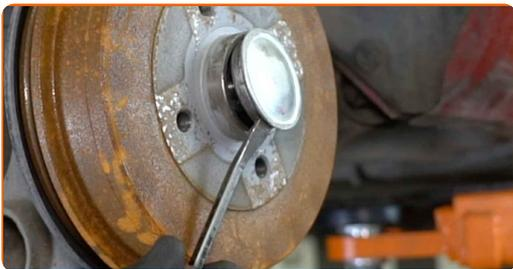
7 Schrauben Sie die Befestigung der Radnabe ab. Verwenden Sie Stecknuss Nr. 30. Verwenden Sie ein Windeisen.
