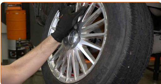
6 Entfernen Sie die Schutzkappe des Nabenlagers. Benutzen Sie ein Brecheisen. Benutzen Sie einen Hammer.
