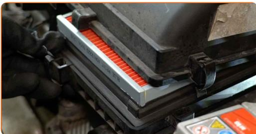
**45** Befestigen Sie die Klammern des Luftfiltergehäuses.
