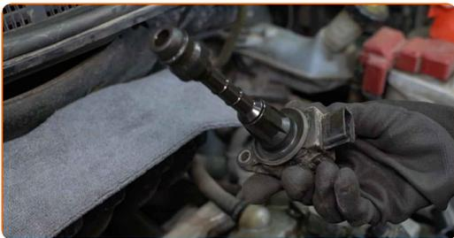
**22** Entfernen Sie Schmutz, Staub und Ablagerungen von den Zündkerzenbohrung.
