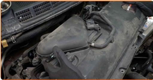
**14** Decken Sie die Ansaugkanäle des Motors mit einem Mikrofaser Tuch ab, um das Eindringen von Staub und Dreck zu verhindern.
