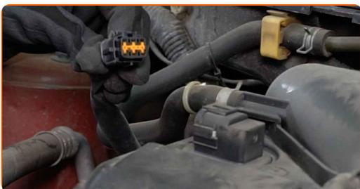
**10** Lösen Sie die Schellen und ziehen Sie die Schläuche von der Motorabdeckung ab. Verwenden Sie eine Spitzzange.
