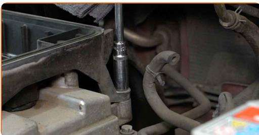
**16** Entfernen Sie die Befestigungsschrauben.
