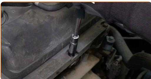
**12** Entfernen Sie die Befestigungsschrauben.
