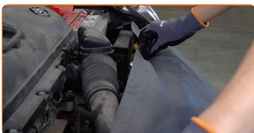
**3** Lösen Sie die Befestigung des Lufteinlassschlauchs. Verwenden Sie einen Lösehebel, um die Clips zu entfernen.
