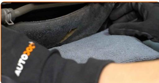
**15** Schrauben Sie die Befestigungsschrauben der unteren Motorabdeckung ab. Verwenden Sie Stecknuss Nr. 10. Verwenden Sie einen Ratschenschlüssel.
