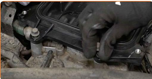
**35** Schrauben Sie die Befestigungsschrauben der unteren Motorabdeckung wieder ein. Verwenden Sie Stecknuss Nr. 10. Verwenden Sie einen Ratschenschlüssel.
