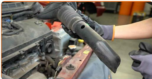
5 Lösen Sie die Klammern des Luftfiltergehäuses.
