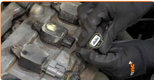
**19** Schrauben Sie die Befestigungsschrauben der Zündspulen ab. Verwenden Sie Stecknuss Nr. 10. Verwenden Sie einen Ratschenschlüssel.
