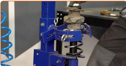
**25** Entfernen Sie das zusammengebaute Federbein.
