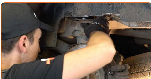
**27** Ziehen Sie die obere Federbeinbefestigung an. Verwenden Sie Stecknuss Nr. 13. Verwenden Sie einen Drehmomentschlüssel. Ziehen Sie ihn mit 56 Nm Drehmoment fest.
