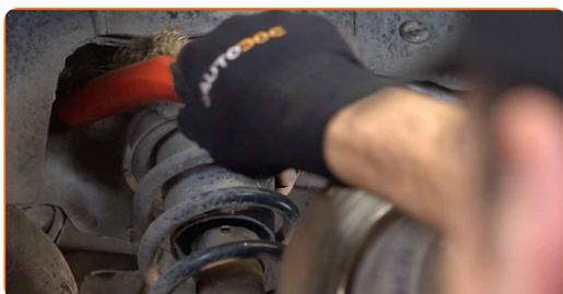
**7** Untere Befestigung der Stoßdämpferfedern abschrauben. Verwenden Sie Stecknuss Nr. 21. Verwenden Sie einen Ratschenschlüssel. Verwenden Sie ein Windeisen.
