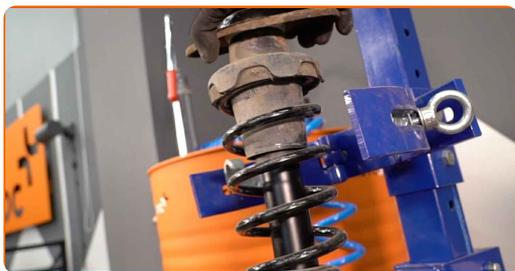
**26** Installieren Sie das Federbein am Radlauf.
