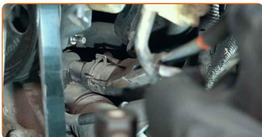
**18** Lösen Sie die Klemmen der Kühlmittelschläuche.
