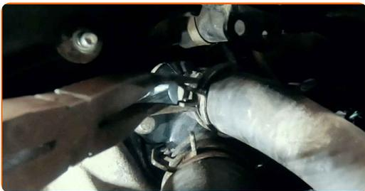
**30** Schrauben Sie die Befestigungselemente der Halterung des hydraulischen Servolenkungsschlauchs an.
