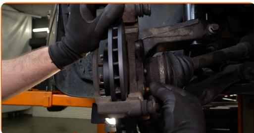
**20** Befestigen Sie die Bremssattelhalterung. Verwenden Sie Stecknuss Nr. 15. Verwenden Sie einen Drehmomentschlüssel. Ziehen Sie ihn mit 100 Nm Drehmoment fest.
