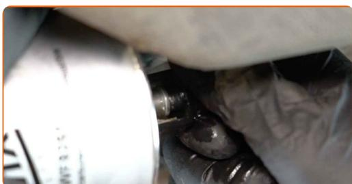
**16** Installieren Sie den Befestigungswinkel des Kraftstofffilters.
