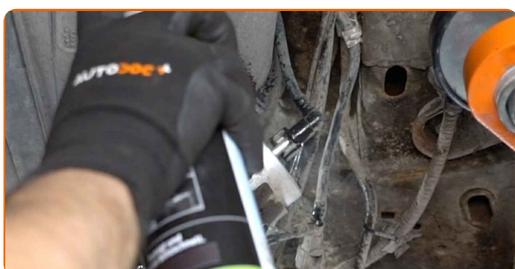
**11** Trennen Sie die Kraftstoffversorgungsleitungen vom Kraftstofffilter.
