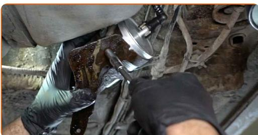
**19** Schrauben Sie die Befestigungsschrauben des Kraftstofffilterhalters ein. Verwenden Sie Stecknuss Nr. 10. Verwenden Sie einen Ratschenschlüssel.
