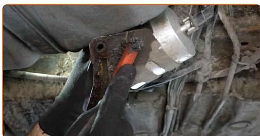
**7** Schrauben Sie die Halterung des Kraftstofffilters ab. Verwenden Sie Stecknuss Nr. 8. Verwenden Sie einen Ratschenschlüssel.
