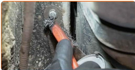
**5** Schrauben Sie die Befestigungsschrauben des Kraftstofffilterhalters ab. Verwenden Sie Stecknuss Nr. 10. Verwenden Sie einen Ratschenschlüssel.
