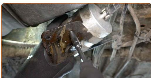
**8** Entfernen Sie den Befestigungswinkel des Kraftstofffilters.
