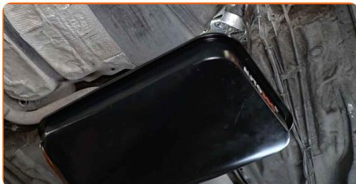
**10** Reinigen Sie die Befestigungen der Kraftstoff-Zuleitungen. Verwenden Sie eine Nylon-Reinigungsbürste. Verwenden Sie Allzweckreinigungsspray.
