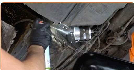
**21** Den Flüssigkeitsbehälter unter dem Kraftstofffilter entfernen.
