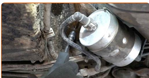
**6** Reinigen Sie den Befestigungssitz des Kraftstofffilters. Benutzen Sie eine Drahtbürste. Benutzen Sie WD-40-Spray.
