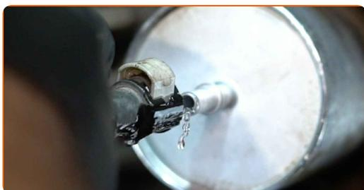
**12** Entfernen Sie den Kraftstofffilter.
