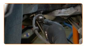
Reinigen Sie die Befestigung des Handbremsseils. Benutzen Sie eine Drahtbürste. Benutzen Sie WD-40-Spray.
