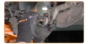
Schrauben Sie die Befestigungen ein, die den Querlenker mit dem Hinterachsgelenk verbinden. Verwenden Sie Stecknuss Nr. 15. Verwenden Sie einen Ratschenschlüssel.
