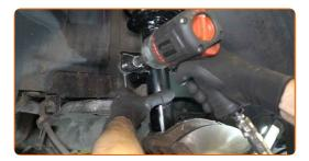
Ziehen Sie das Befestigungselement an, das die Druckstange mit dem Federbein verbindet. Verwenden Sie Stecknuss Nr. 17. Verwenden Sie einen Drehmomentschlüssel. Ziehen Sie ihn mit 48 Nm Drehmoment fest.
