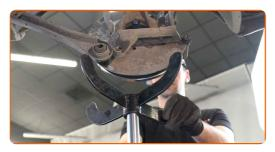
Lösen Sie die Befestigung, die den Stoßdämpfer mit dem hinteren Achsschenkel verbindet. Verwenden Sie eine spezielle Schraubnuss, um den Stoßdämpfer zu entfernen. Verwenden Sie einen Ratschenschlüssel.
