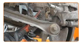
Entfernen Sie das Handbremsseil. Verwenden Sie eine Kneifzange. Benutzen Sie ein Brecheisen.
