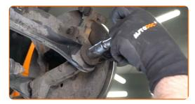
Ziehen Sie die Befestigung, die das Federbein mit dem hinteren Achsschenkel verbindet, fest. Verwenden Sie Stecknuss Nr. 18. Verwenden Sie einen Drehmomentschlüssel. Ziehen Sie ihn mit 85 Nm Drehmoment fest.
