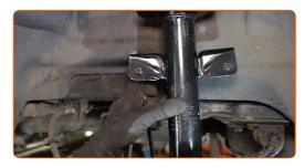
Ziehen Sie die Befestigungselemente des Stabilenkers fest. Verwenden Sie Stecknuss Nr. 17. Verwenden Sie einen Ratschenschlüssel.
