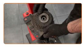
Ziehen Sie die Federbeinkolbenstangenmutter an. Verwenden Sie Stecknuss Nr. 19. Verwenden Sie Inbusschlüssel Nr. H6. Verwenden Sie einen Drehmomentschlüssel. Ziehen Sie ihn mit 50 Nm Drehmoment fest.
