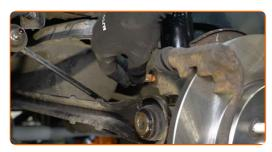
Schrauben Sie die Befestigung an, die den Stoßdämpfer mit dem hinteren Achsschenkel verbindet. Verwenden Sie Stecknuss Nr. 18. Verwenden Sie einen Ratschenschlüssel.
