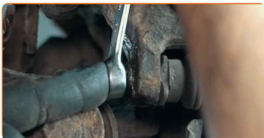
**10** Entfernen Sie den Bremssattel. Benutzen Sie ein Brecheisen.
