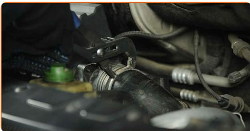
**17** Behandeln Sie den Steckverbinder des Luftmassenmessers. Verwenden Sie dielektrisches Fett.
