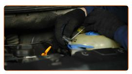
Lockern Sie die Klemme des Kühlmittelschlauchs. Verwenden Sie eine Clic-R-Kragenzange.
