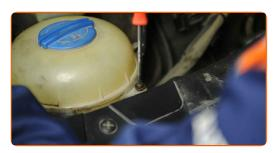
Befestigen Sie den Kühlmittelbehälterschlauch.
