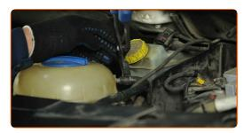
Ziehen Sie den Kühlmittelbehälterschlauch ab. Verwenden Sie einen flachen Schraubendreher.
