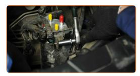
Bringen Sie die Kraftstoffleitungen an den neuen Kraftstofffilter an.
