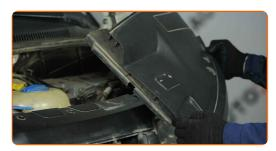
Lösen Sie den Steckverbinder des Kühlmittelausgleichsbehälters. Verwenden Sie einen flachen Schraubendreher.
