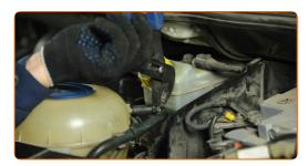
Befestigen Sie den Steckverbinder des Kühlmittelausgleichsbehälters.
