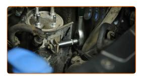
Entfernen Sie den Kraftstofffilter. Verwenden Sie einen flachen Schraubendreher. Legen Sie die alte Filterpatrone in den Behälter.
