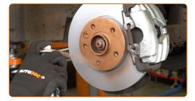
Die Bremsscheibenoberfläche reinigen. Benutzen Sie einen Bremsenreiniger.
