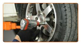
Senken Sie das Auto und ziehen Sie die Radschrauben über Kreuz an. Verwenden Sie eine Schlagnuss für Felgen # 19. Verwenden Sie einen Drehmomentschlüssel. Ziehen Sie ihn mit 180 Nm Drehmoment fest.
