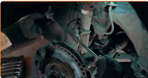
**5** Um zu verhindern, dass sich der Zapfen beim Anziehen oder Lösen der Befestigungselemente dreht, sollten Sie ihn durch Einsetzen eines Inbusschlüssels in einen speziellen Schlitz sichern.
