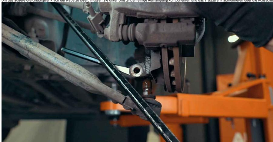
Die Verzahnung auf dem äußeren Gleichlaufgelenk steckt für gewöhnlich in der Nabe fest und sollte daher herausgeschlagen werden
