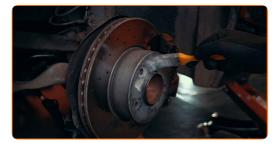
Reinigen Sie die Bremsfläche der Bremsscheibe
