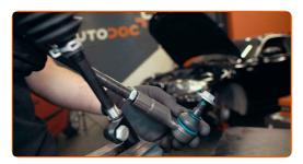
Reinigen Sie vor der Montage des neuen Bauteils die Zahnstange von altem Schmiermittel und tragen Sie neues auf
