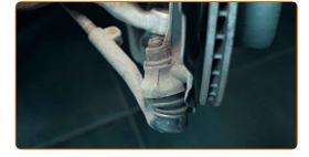
Reinigen Sie das Befestigungselement, das das Teil mit dem Achsschenkel verbindet
