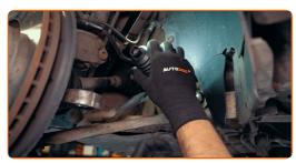
oder markieren Sie das Gewinde der Spurstange, montieren Sie diese auf der Zahnstange und bringen Sie die Manschette an
