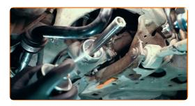
Tragen Sie Schraubensicherung auf das Gewinde auf und schrauben Sie die neue Spurstange ein
