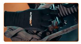
Schrauben Sie die Spurstange ab, nachdem Sie zuvor den Spurstangenkopf gesichert haben
