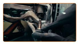
Entfernen Sie die Manschettenklemmen und die Manschette, um an das Befestigungselement an der Zahnstange heranzukommen
