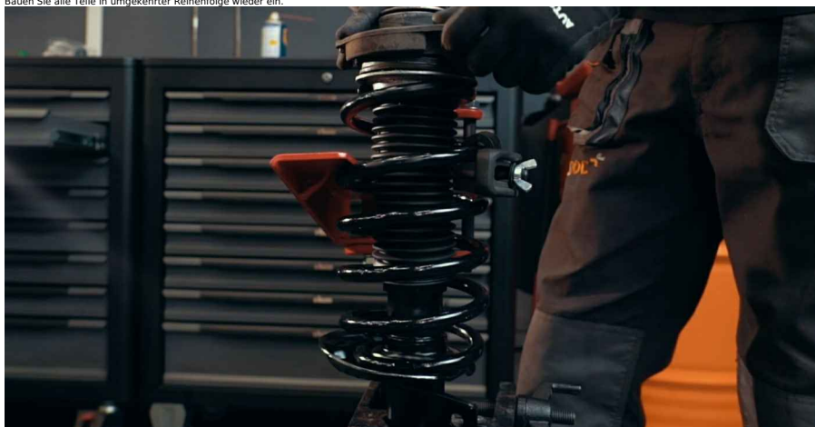
Wichtiger Hinweis! • Achten Sie auf die Position des Federbeinlagers, um sicherzustellen, dass es in die richtige Richtung zeigt
