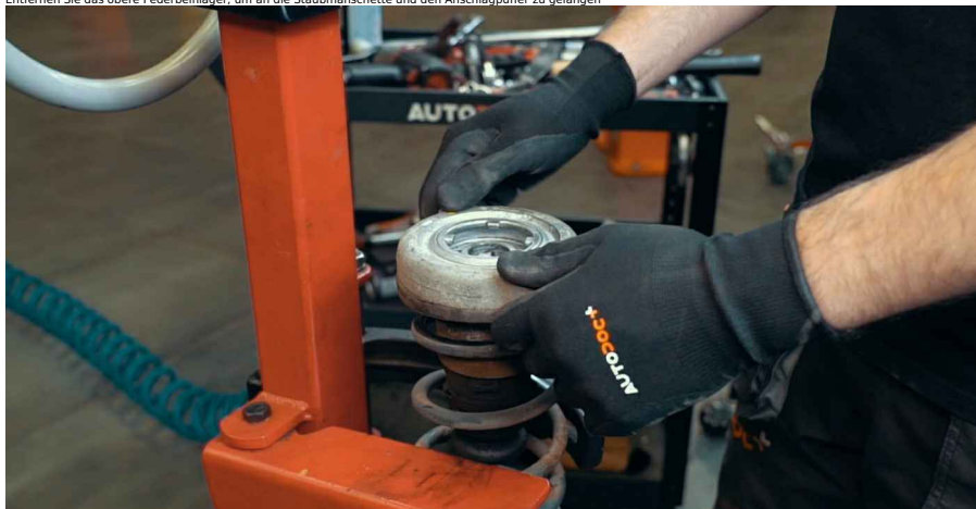
Bitte beachten Sie! • Der Anschlagpuffer kann an der Kolbenstange montiert oder am Lager befestigt sein • Die Staubmanschette kann auf dem Anschlagpuffer montiert, zwischen der Feder und dem Lager angebracht oder am Lager befestigt sein.
