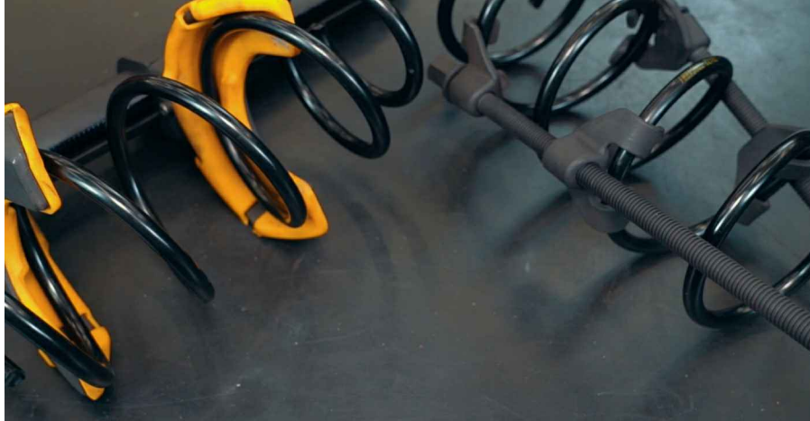
12 Verwenden Sie einen speziellen Federspanner
