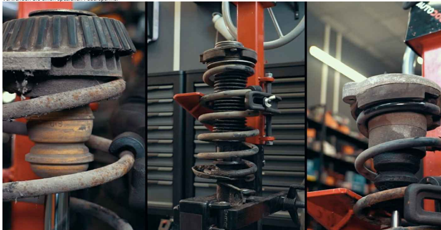
13 Entfernen Sie das obere Federbeinlager, um an die Staubmanschette und den Anschlagpuffer zu gelangen
