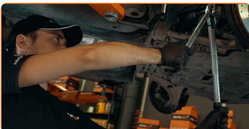
**21** Tragen Sie auf die Schraubverbindungen ein Korrosionsschutzmittel auf
