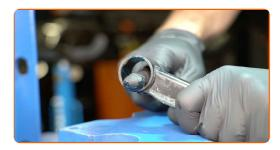
Drücken Sie die neue Buchse hinein. Stellen Sie sicher, dass die Buchse in einem 90-Grad-Winkel eingesetzt wird. Andernfalls könnten Sie sowohl die Buchse als auch die Komponente, in die sie eingebaut wird, beschädigen.
