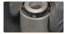
Behandeln Sie die Buchse mit einem WD-40-Spray und drücken Sie sie heraus.
