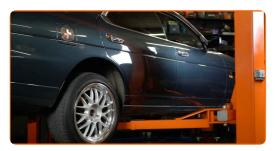
Lösen Sie die Radbefestigungen und nehmen Sie das Rad ab.
