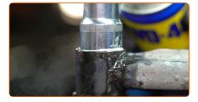
Verwenden Sie für den Montagesitz eine Drahtbürste. Verwenden Sie gegebenenfalls einen Winkelschleifer.
