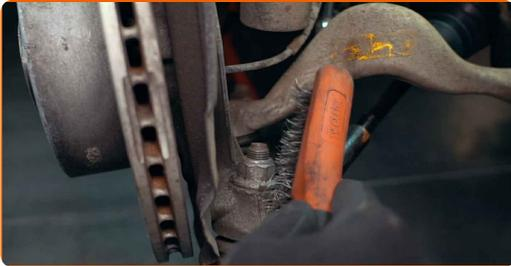
Die Schraubverbindung des Spurstangenkopfs mit der Spurstange wird zusätzlich gesichert
