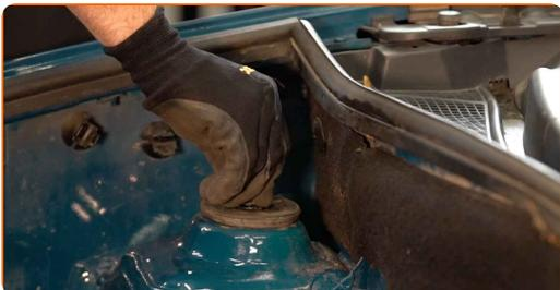
**41** Entfernen Sie die Kotflügel-Abdeckung.
