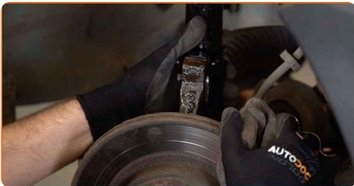
**34** Entfernen Sie den Träger unter dem Achsschenkel.
