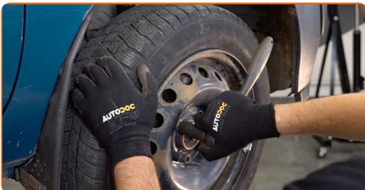
**38** Senken Sie das Auto und ziehen Sie die Radschrauben über Kreuz an. Verwenden Sie eine Schlagnuss für Felgen # 19. Verwenden Sie einen Drehmomentschlüssel. Ziehen Sie ihn mit 110 Nm Drehmoment fest.
