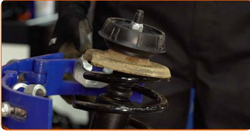
**29** Entfernen Sie das zusammengebaute Federbein.
