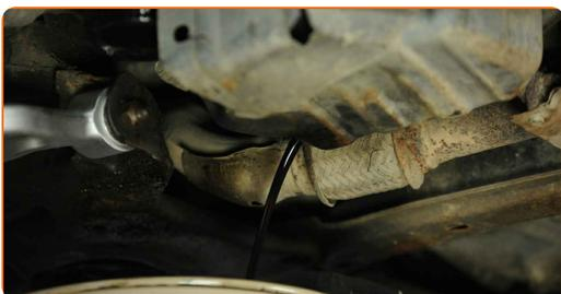
**Austausch: Motoröl und Ölfilter – NISSAN NP300 Navara Pritsche / Fahrgestell (D40). Tipp von AUTODOC:**
