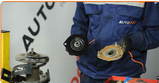
**22** Ziehen Sie die Federbeinkolbenstangenmutter an. Verwenden Sie Ring-Gabelschlüssel Nr. 17. Verwenden Sie einen Drehmomentschlüssel. Ziehen Sie ihn mit 60 Nm Drehmoment fest.
