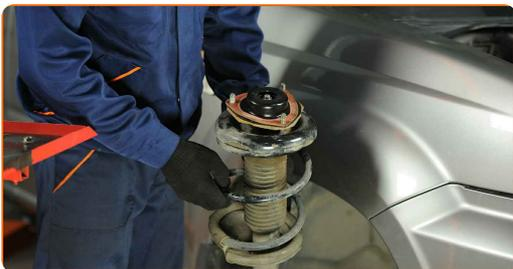
**25** Installieren Sie das Federbein am Radlauf.
