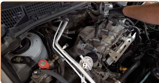
**15** Entfernen Sie allen Schmutz, Staub und Rückstände aus dem Inneren der Vertiefung für die Zündkerze.
