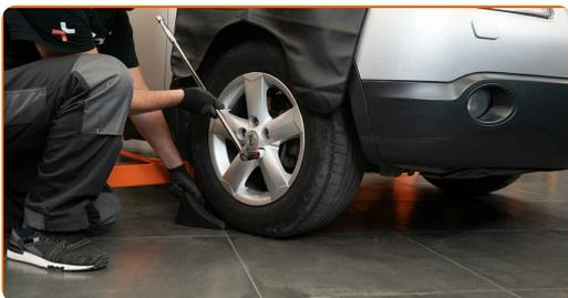
**4** Lösen Sie die Radhalterungsschrauben. Verwenden Sie eine Schlagnuss für Felgen # 21.
