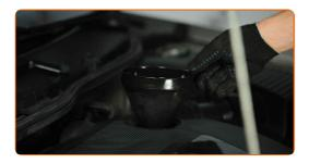
Füllen Sie Öl durch den Einfüllstutzen in den Motor. Erforderliche Menge an Öl: 4,5 l.
