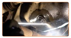
Schrauben Sie den Ölfilter ab. Verwenden Sie Steckschlüssel 76/14-F. Verwenden Sie einen Ratschenschlüssel.
