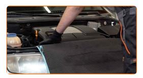
16 Entfernen Sie die Öleinfüllschraube.
