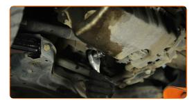
Reinigen Sie den Bereich um die Ablassöffnung der Ölwanne. Verwenden Sie Allzweckreinigungsspray.
