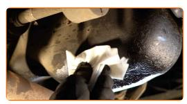
Schrauben Sie die neue Ablassschraube ein und ziehen Sie sie fest. Verwenden Sie Stecknuss Nr. 19. Verwenden Sie einen Drehmomentschlüssel. Ziehen Sie ihn mit 30 Nm Drehmoment fest.
