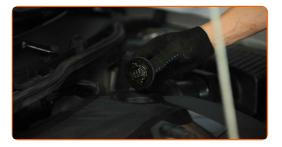
Befestigen Sie den Deckel des Öleinfüllstutzens.
