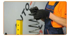
Reinigen Sie die Aufnahmen der Spiralfedern. Benutzen Sie eine Drahtbürste.
