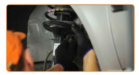
Reinigen Sie die untere Befestigung, die das Federbein mit dem Achsschenkel verbindet. Benutzen Sie eine Drahtbürste. Benutzen Sie WD-40-Spray.
