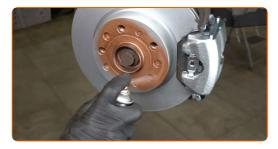
Die Bremsscheibenoberfläche reinigen. Benutzen Sie einen Bremsenreiniger.
