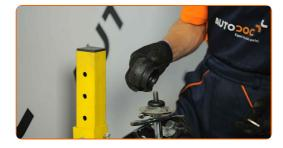
Ziehen Sie die Federbeinkolbenstangenmutter an. Verwenden Sie Stecknuss Nr. 20.6. Verwenden Sie Inbusschlüssel Nr. H6. Verwenden Sie einen Drehmomentschlüssel. Ziehen Sie ihn mit 60 Nm Drehmoment fest.
