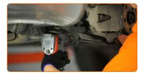
Entfernen Sie die Befestigungsschraube.
