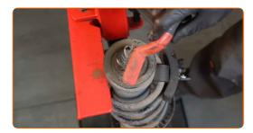
Entfernen Sie die Stangenmutter des Federkolben. Verwenden Sie Stecknuss Nr. 20.6. Verwenden Sie einen Ratschenschlüssel.
