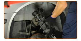
Stellen Sie das Dämpferbein auf das Federspannwerkzeug.
