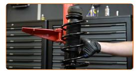
Installieren Sie das Federbein am Radlauf.
