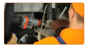
Entfernen Sie die Befestigungsschraube.
