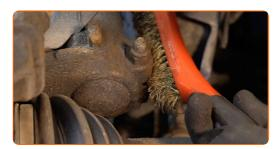
Schrauben Sie das untere Befestigungselement ab, dass das Federbein mit dem Achsschenkel verbindet. Verwenden Sie Ring-Gabelschlüssel Nr. 18. Verwenden Sie Stecknuss Nr. 18. Verwenden Sie einen Ratschenschlüssel.
