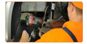
Montieren Sie den Querlenker.
