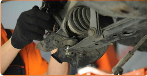
**22** Trennen Sie das Kugelgelenk vom Achsschenkel. Verwenden Sie einen Kugelgelenkabzieher.
