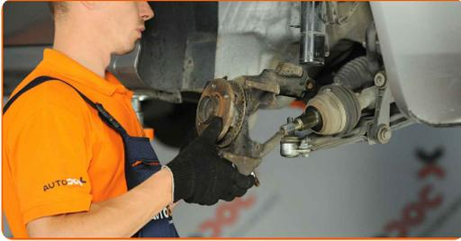
**38** Befestigen Sie das Dämpferbein auf dem Achsschenkel. Verwenden Sie einen Gummi-Hammer.
