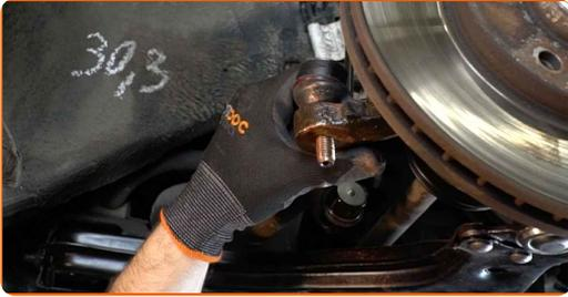
50 Ziehen Sie die Befestigungsmutter an, die den Spurstangenkopf mit dem Achsschenkel verbindet. Verwenden Sie Stecknuss Nr. 19. Verwenden Sie einen Drehmomentschlüssel. Ziehen Sie ihn mit 45 Nm Drehmoment fest.
