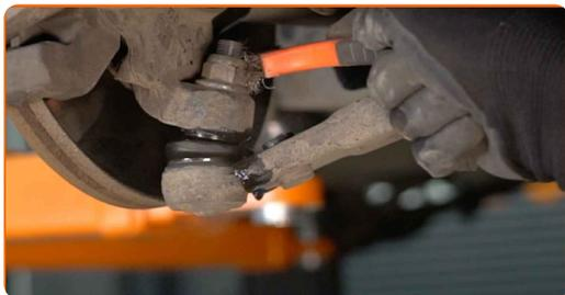
**21** Schrauben Sie die Kugelgelenkbefestigung vom Achsschenkel ab. Verwenden Sie Ring-Gabelschlüssel Nr. 19.
