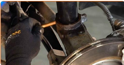
**40** Schrauben Sie die unteren Befestigungen des Federbeins fest. Verwenden Sie Ring-Gabelschlüssel Nr. 18. Verwenden Sie Stecknuss Nr. 18. Verwenden Sie einen Drehmomentschlüssel. Ziehen Sie ihn mit 60 Nm Drehmoment fest.+90°
