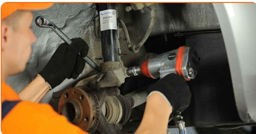
25 Entfernen Sie die Befestigungsschraube.
