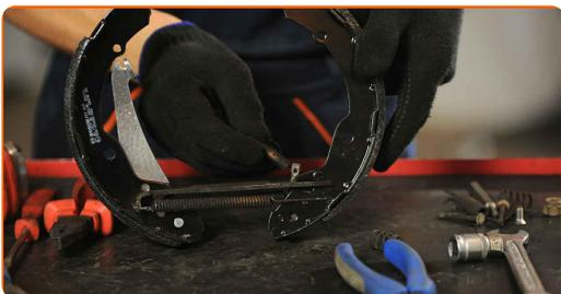
**17** Reinigen Sie die Montagesitze der Bremsbacken. Benutzen Sie eine Drahtbürste.
