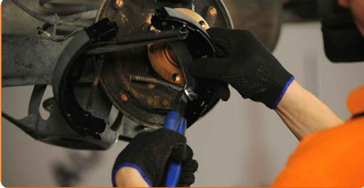
**20** Montieren Sie die Bremsbacken am Bremszylinder an der Halterung und am Bremsträger.
