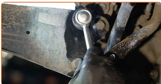
**12** Ziehen Sie die Befestigungselemente des Stabilenkers fest. Verwenden Sie Ring-Gabelschlüssel Nr. 16. Verwenden Sie Stecknuss Nr. 16. Verwenden Sie einen Ratschenschlüssel.
