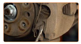
Entfernen Sie den Bremssattel.
