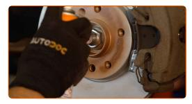
Die Bremsscheibenoberfläche reinigen. Benutzen Sie einen Bremsenreiniger.
