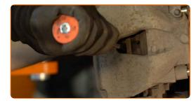
Ziehen Sie die Bremssattel-Haltefeder zur Seite. Benutzen Sie ein Brecheisen.
